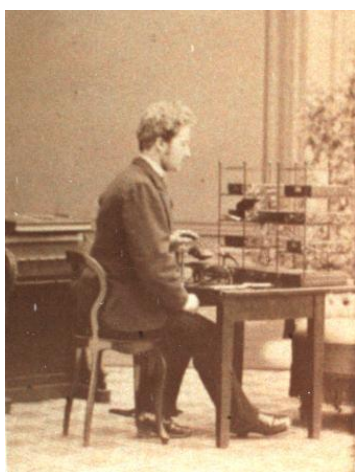
3 gamle fotografier. Til venstre: En "kugleskriver". Skrivekuglen er ganske høy, og bør derfor anbringes på et relativt lavt bord, for å få en god skrivestilling. I midten: Malling-Hansens oppfinnelse var gjenstand for stadige forbedringer, og finnes i en rekke utgaver. Antagelig ble gamle "kugler" framontert og satt på nyere modeller etter hvert. Til høyre: I annonsene for skrivekuglen het det at den kunne brukes av enhver, f.eks. av den som led av skjelving på hånden.
